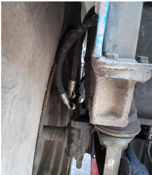
Фото 4,4А Установка трубопроводов к задней навески трактора
